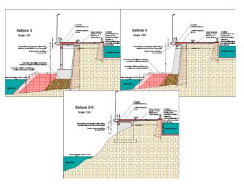
fra varie alternative esaminate, quella della realizzazione di un nuovo muro in c.a. sostanzialmente allineato alla trave esterna dell'infrastruttura stradale che si intende mettere in sicurezza appare meno costosa e preferibile anche dal punto di vista della durabilità nel tempo e della minore durata del cantiere;
