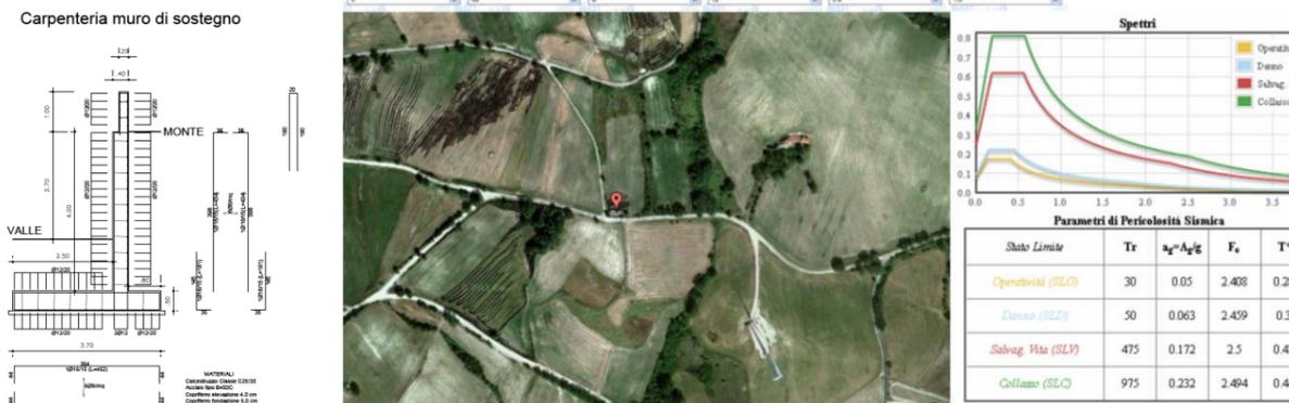
Esempio di Carpenteria e Spettro di risposta elastico in accelerazione delle componenti orizzontali utilizzato in progetto
