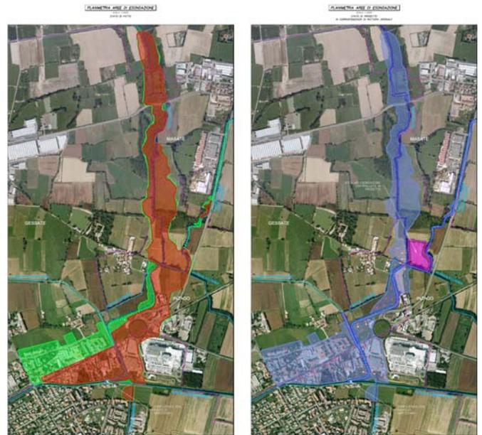
Planimetrie aree di esondazione allo stato di fatto e a seguito di rottura arginale.
